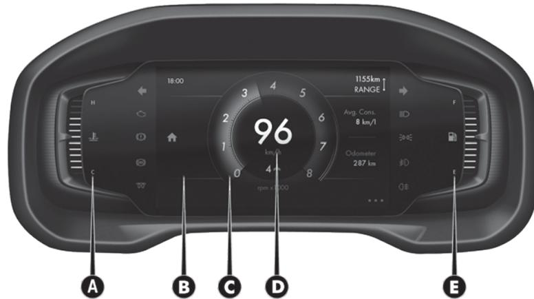
A- Indicador digital de la temperatura del líquido de enfriamiento del motor – B- Pantalla multifunción – C- Tacómetro (cuentarrevoluciones) – D- Velocímetro digital – E- Indicador digital del nivel de combustible con testigo de reserva.
