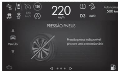
Si el sistema detecta que uno o más neumáticos están con presión inferior a la de la condición inicial de monitoreo (realizada tras la calibración y puesta a cero), deberá hacer la indicación a través de un pop-up en la pantalla y del encendido del testigo
