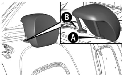
Regulación para subir: elevar el apoyacabeza hasta oír su ruido de bloqueo en la posición deseada (dos posiciones).
