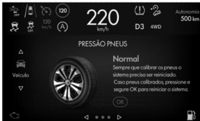
El sistema iTPMS señala al conductor la eventual presencia de una condición de presión de llenado diferente de la condición en el momento de la puesta en marcha, si la presión
