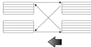
Tras el procedimiento de rotación de los neumáticos, se debe hacer la puesta a cero (reset) del sistema iTPMS para correcta indicación.
