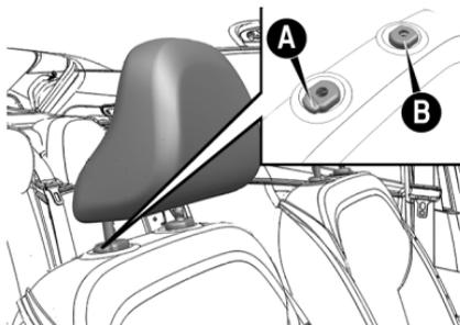
Para quitar el apoyacabezas, presionar el botón de la izquierda **A** y de la derecha **B** y levantar el apoyacabezas hasta liberarlo de la tercera traba. Soltar los botones y tirar hacia arriba hasta sacarlo totalmente del apoyo de su vástago.
