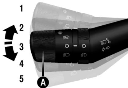
1. Indicador de dirección lado derecho (segundo nivel - posición fija).
