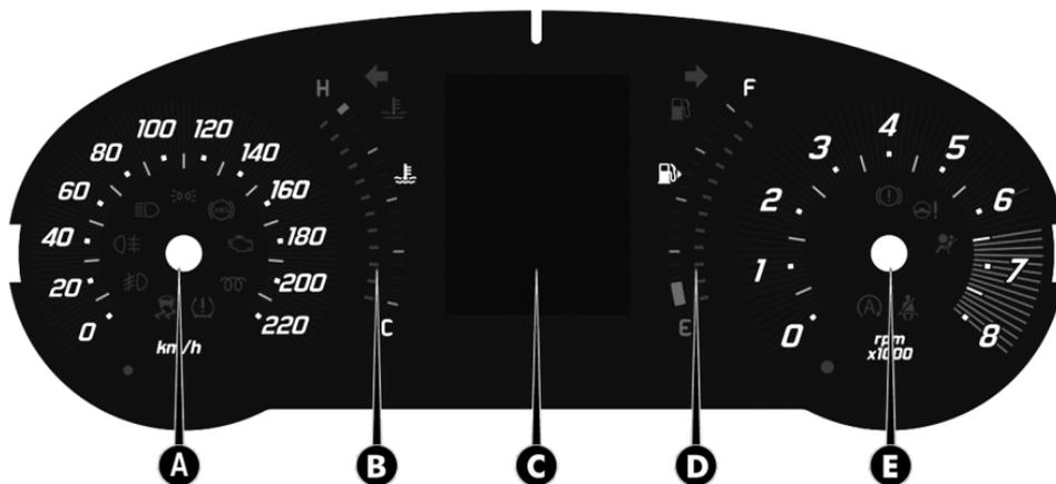
A- Velocímetro – B- Indicador digital de la temperatura del líquido de enfriamiento del motor con luz de aviso de temperatura máxima – C- Pantalla multifunción – D- Indicador digital de nivel de combustible con luz de aviso de límite mínimo (el triángulo presente en el lado derecho o abajo del símbolo indica en cual lado del vehículo está la boquilla para el suministro de combustible) – E- Tacómetro (cuentarrevoluciones)
