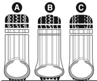
**A** - presión normal: la banda de rodamiento se gasta de manera uniforme.
