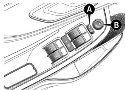
Para plegar o abrir el retrovisor utilizando el mando de la puerta es necesario mantener el selector de retrovisor **A** en la posición central y apre-
