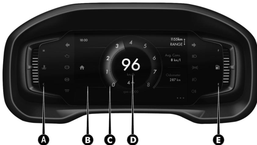
A- Indicador digital de la temperatura del líquido de enfriamiento del motor – B- Pantalla multifunción – C- Tacómetro (cuentarrevoluciones) – D- Velocímetro digital – E- Indicador digital del nivel de combustible con testigo de reserva.
