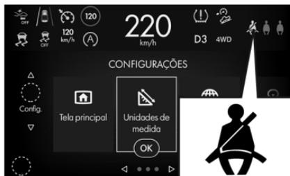
Con el vehículo detenido, si se desabrocha el 1 cinturón de seguridad del lado del conductor, la luz permanece prendida con luz fija.
