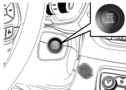
Para activar el conmutador de arranque es preciso que la llave electrónica esté en el interior del habitáculo.
