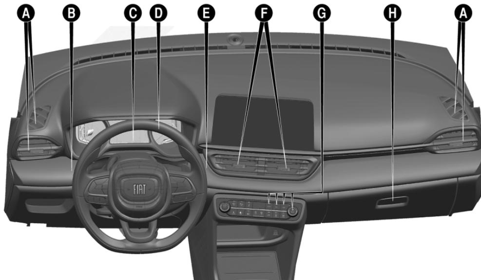
A- Difusores de aire laterales – B- Palanca izquierda (control del faro alto/bajo y luces de dirección) – C- Cuadro de instrumentos – D- Volante – E- Palanca derecha (control de limpieza/lavado de los vidrios) – F- Difusores de aire centrales – G- Botones de control del aire acondicionado – H- Guantera
