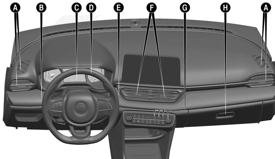
A- Difusores de aire laterales – B- Palanca izquierda (control del faro alto/bajo y luces de dirección) – C- Cuadro de instrumentos – D- Volante – E- Palanca derecha (control de limpieza/lavado de los vidrios) – F- Difusores de aire centrales – G- Botones de control del aire acondicionado – H- Guantero
