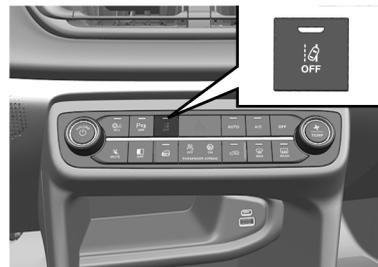
Un mensaje en la pantalla del tablero de instrumentos indicará que el sistema fue activado: "Alerta de salida de carril activado".
