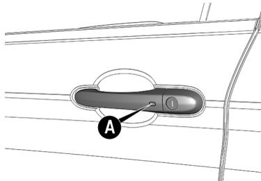
Si se detecta una de las llaves electrónicas en el interior del vehículo y no se detecta ninguna otra llave electrónica habilitada en el exterior del vehículo, las puertas del vehículo no se bloquean al accionarse el botón de bloqueo de puertas.
