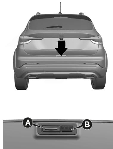
El botón **B**, ubicado a la derecha en la parte inferior de la tapa, tiene la función de bloquear las puertas del vehículo.
