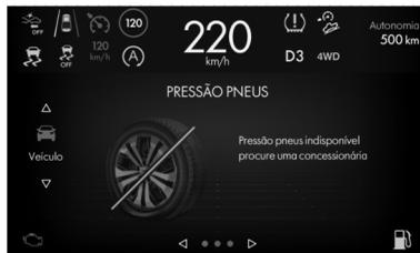
Si el sistema detecta que uno o más neumáticos están con presión inferior a la de la condición inicial de monitoreo (realizada tras la calibración y puesta a cero), deberá hacer la indicación a través de un pop-up en la pantalla y del encendido del testigo (⚠) en el cuadro de instrumentos.
