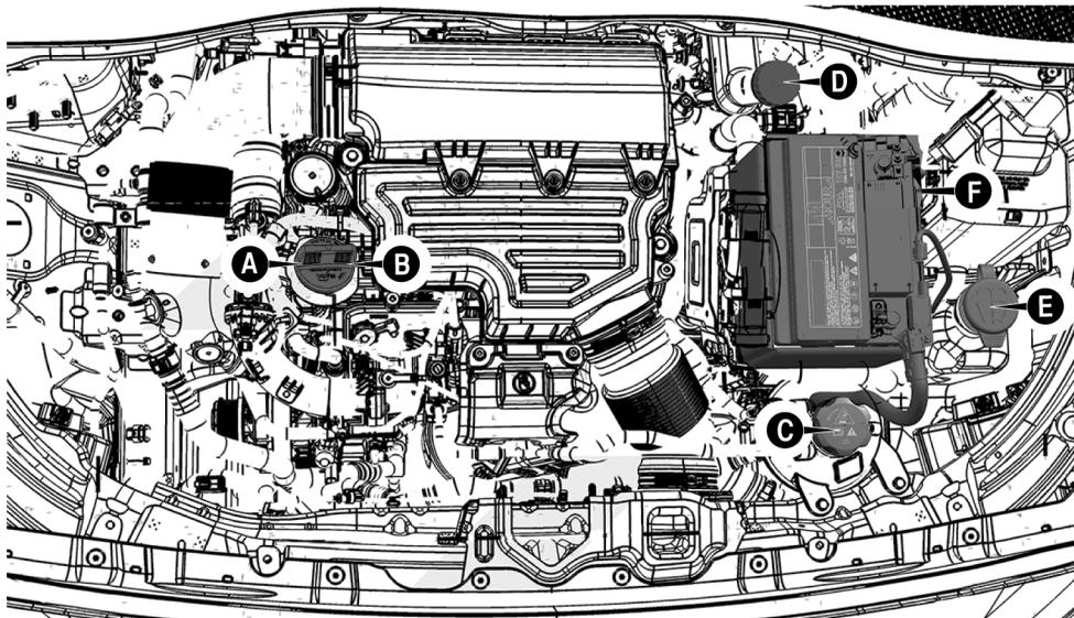
A. Varilla de control del nivel de aceite del motor – B. Tapa / suministro de aceite del motor – C. Líquido de enfriamiento del motor – D. Líquido de los frenos – E. Líquido del lavador del parabrisas y luneta trasera – F. Batería
