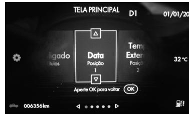
Hora, Gear Shift Indicator (indicaciones de cambio de marchas) (si está equipado), temperatura exterior, fecha, velocidad del vehículo, mensajes de advertencia, kilometraje total recorrido e íconos de eventuales señalizaciones de avería.
