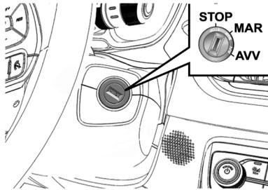
El conmutador de encendido está equipado con un mecanismo de seguridad que exige que, en caso de falla en el arranque del motor, se ponga la llave en la posición **STOP** antes de repetirse la maniobra de arranque.
