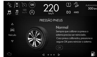
El sistema iTPMS señala al conductor la eventual presencia de una condición de presión de llenado diferente de la condición en el momento de la puesta en marcha, si la presión
