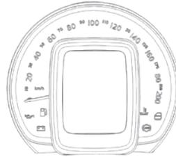
El kilometraje total y parcial se pueden visualizar a través del botón **TRIP** ubicado en la extremidad de la palanca derecha.
